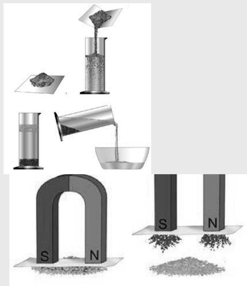
Отстаивание      Магнитная сепарация
