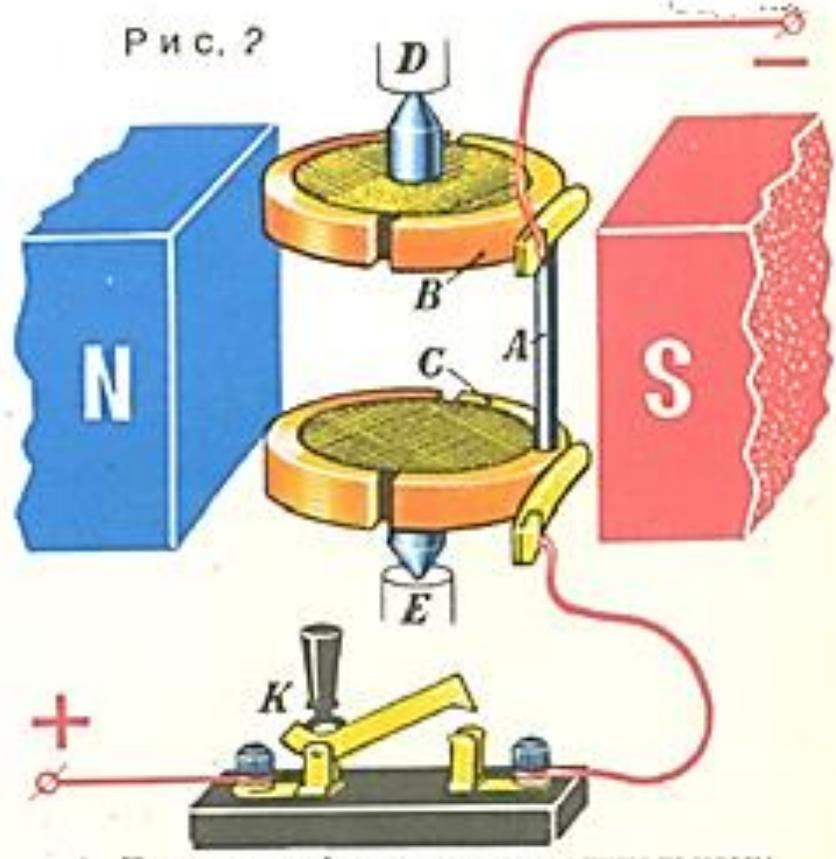
2. Проводник A соединен с полукольцами B и C (рис. 2), которые укреплены на изоляционных дисках. Диски имеют оси, установленные в подшипниках D и E. На полукольца наложены щетки, соединенные с источником тока.
