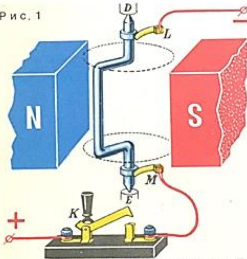
1. Между полюсами магнита находится П-образный проводник (рис. 1), концы которого установлены в подшипниках D и E. На концы проводника наложены щетки L и M.
